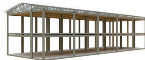
Каркас здания GALLERY-5F2 (MD6, 384,1 м 2 )
