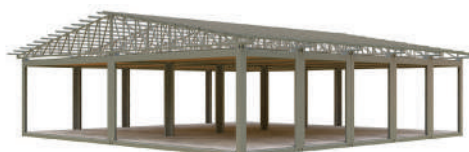
Каркас здания RYAD-5 (MD6, 146,1 м 2 )
