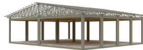
Каркас здания RYAD-4 (MD6, 117 м 2 )
