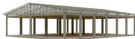
Каркас здания RYAD-6 (MD6, 176 м 2 )
