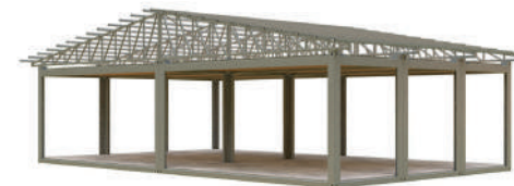
Каркас здания RYAD-3 (MD6, 88 м 2 )
