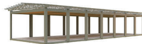
Каркас здания LINE-7 (MD6, 102,27 м 2 )
