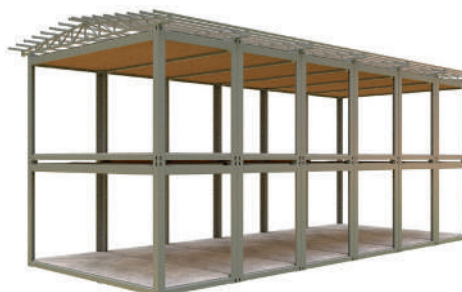
Каркас здания LINE-6F2 (MD6, 175,32 м 2 , 2-х этажный)
