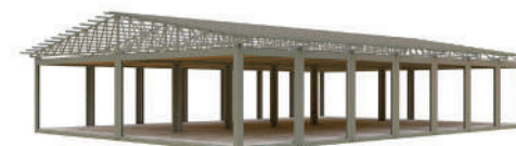
Каркас здания RYAD-7 (MD6, 204,54 м 2 )
