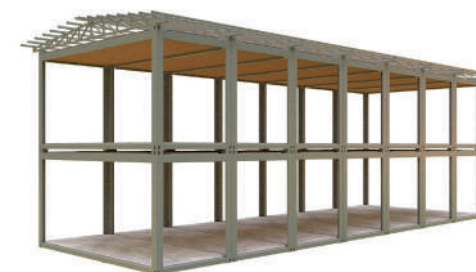
Каркас здания LINE-7F2 (MD6, 204,54 м 2 , 2-х этажный)
