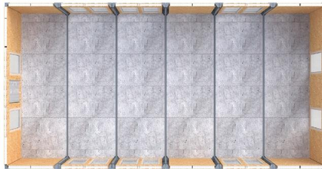
**GALLERY**-вариант сборки из двух модулей MD-6 (6x2,45 метра) соединенных с одним модулем MD-5 (5x2,45 метра) необходимое количество раз. В серии GALLERY одна из сторон всегда равна 8,5 метров, а вторая сторона может быть любой длины, но с шагом всегда равным 5-и метрам (5,10,15,20,25 и т.д.). Пример, "GALLERY-3" обозначает здание шириной 8,5 м и длиной 5x3=15 метров.
