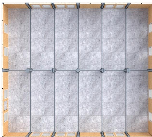
**HOLL**-вариант сборки здания из двух четырех MD-6 (6х2,45 метра) соединенных с одним модулем MD-5 (6х2,45 метра). Указанная компоновка может повторяться для создания больших зданий. В серии HOLL одна из сторон здания всегда равна 14,5 метров, а вторая сторона может иметь любую длину кратную 5-и метрам (5; 10; 15; 20; 25 и т.д.). Пример, "HOLL-4" обозначает здание шириной 14.5 метров и длиной 5 x 4=20 метров.
