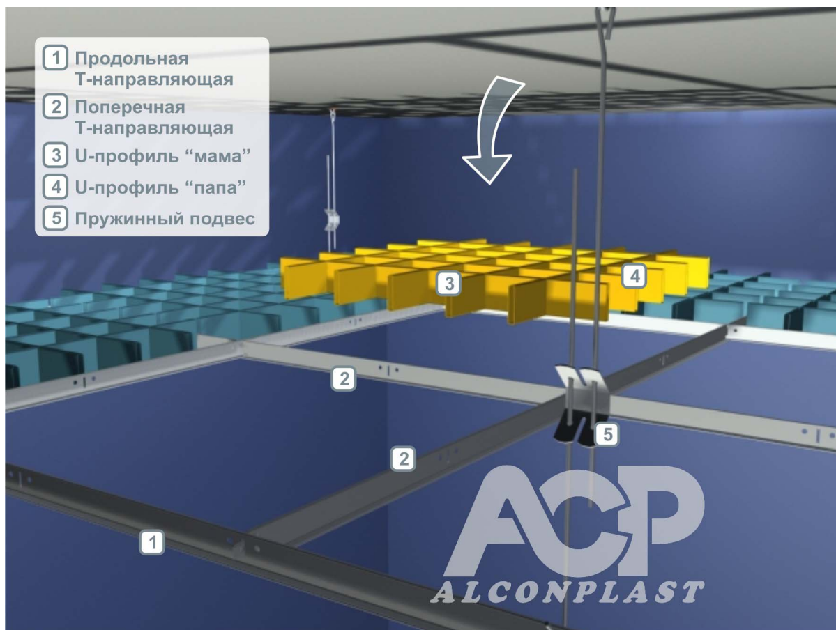
Рис.3.3. Установка модулей (Несущий каркас из Т-направляющих).
