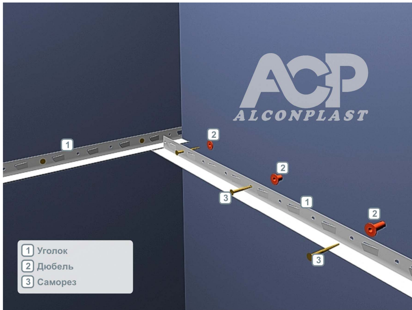
Рис.3.1. Крепление уголков (перекрытие условно не показано).
